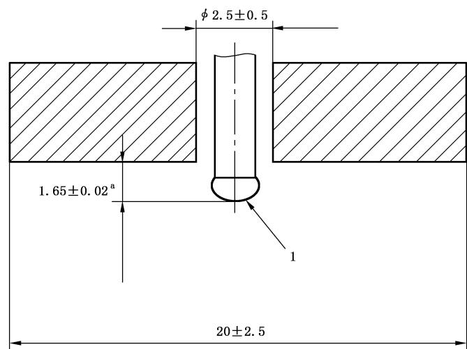
1——半球形压针(直径  $1.575 \text{ mm} \pm 0.025 \text{ mm}$ )。<sup>a</sup> 硬度示值为 30 IRHD。
